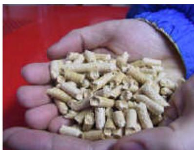
Bild 1. Pellets 6mm
