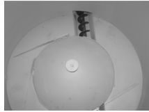
Brennstoffmischer mit Kegel und Flügeln
